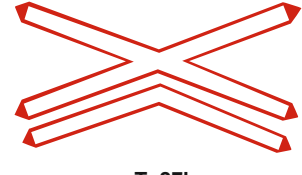
T- 27b Kontrolsüz Demiryolu Geçidi (Çift Hat )
